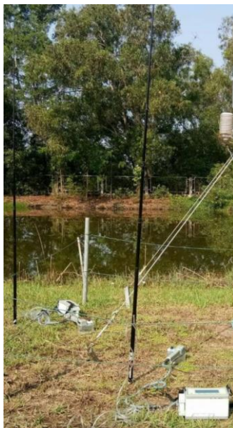
ภาพที่ 3.5 Open Dynamic Closed chamber แบบโปร่งแสง และ Air supply pipe สำหรับดูดอากาศให้เครื่อง IRGA วัดความเข้มข้นของ CO 2
