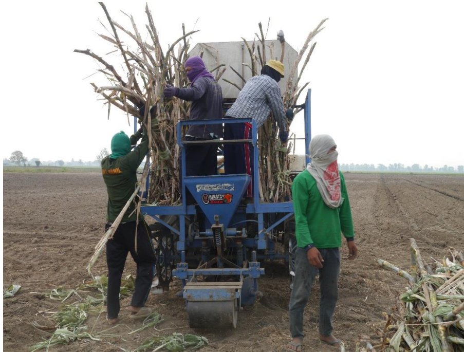
รูปที่ 13 การปลูกอ้อยด้วยรถแทรกเตอร์ ชุดหลุม รดน้ำ ใส่ปุ๋ยรองก้นหลุม สับท่อนพันธุ์ลงปลูก และฝังกลบในชั้นตอนเดียว
