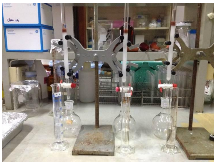
รูปที่ 3.6 การสกัดแยกส่วนด้วยวิธี Column Chromatography โดยใช้ Silica gel column
