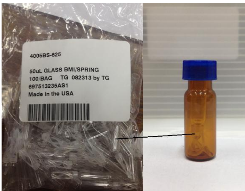
รูปที่ 3.8 ขวด Screw Vial ชนิดฝาเป็น Silicone Septa สำหรับบรรจุสารละลาย PAHs สุดท้ายก่อนนำไปวิเคราะห์ด้วยเครื่อง GC-MS
