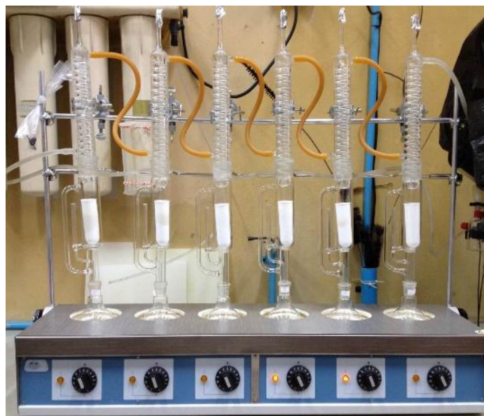
รูปที่ 3.5 การสกัดดินตะกอนด้วยวิธีสกัดแบบ Soxhlet
