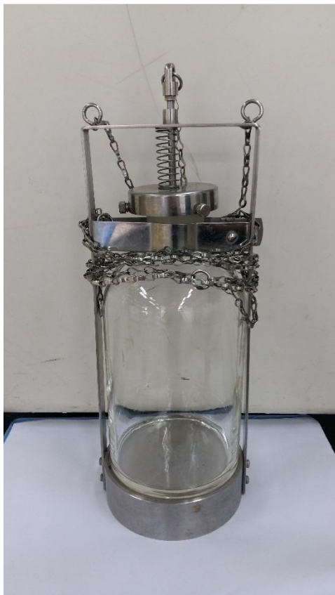
รูปที่ 3.4 เครื่องเก็บตัวอย่างน้ำ (Water Sampler)
