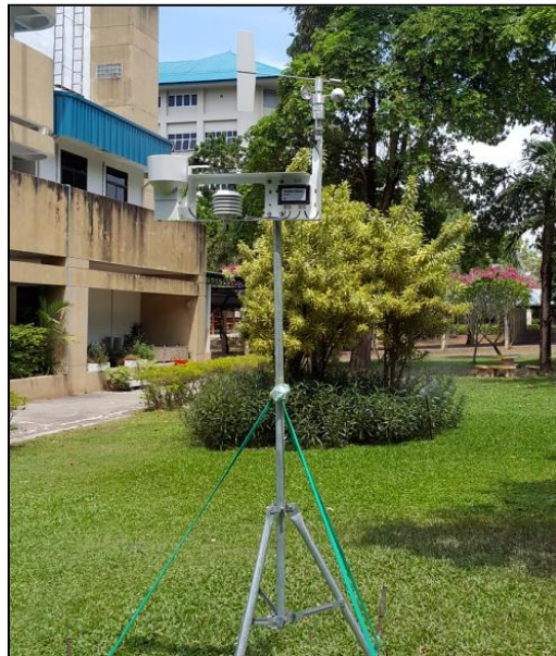
รูปที่ 3.4 เครื่อง Weather Station
