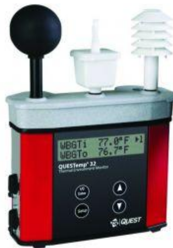
ภาพที่ 3.9 เครื่องวัดดัชนีความร้อนในภาคสนาม
